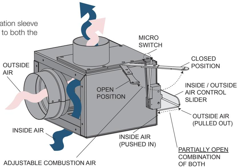
**ADJUSTABLE COMBUSTION AIR CONTROL LEVER**
