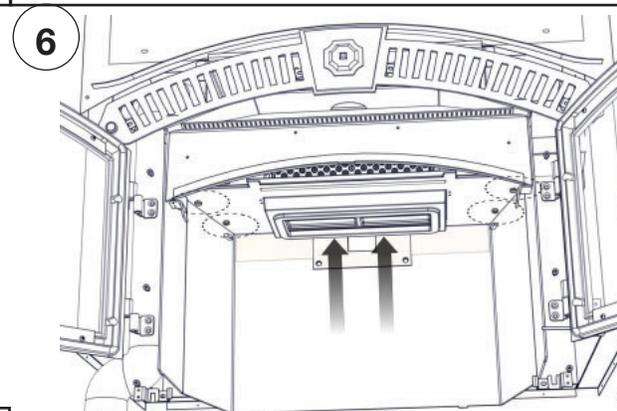
Retirez le collecteur d'air secondaire en le faisant glisser vers le bas et vers l'extérieur. Gratter le joint d'étanchéité de l'arrière puis nettoyez le surface. Fixez le nouveau joint d'étanchéité avec du silicone haute température (non fourni).
