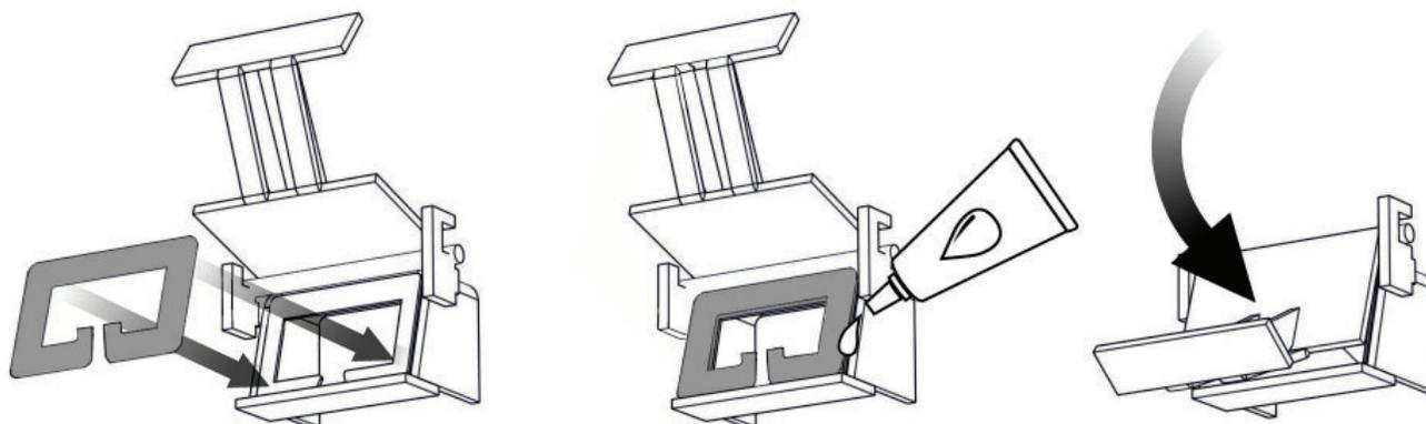
Appliquez un nouveau joint d'étanchéité en le fixant à l'aide de ciment à poêle (non fourni). Ceci afin d'éviter l'effilochage des extrémités et de fixer le joint d'étanchéité dans la position de l'encoche.
