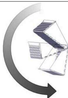
Réinstallez le panier perforé dans l'ordre inverse. Assurez-vous que le panier repose sur les boulons à épaulement de l'étape 2. Réinstallez le déflecteur en fibre.
