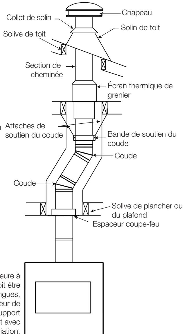
Si la longueur de la déviation est supérieure à 36" (91,4cm), un support intermédiaire doit être utilisé. Pour obtenir des déviations plus longues, vous pouvez installer n'importe quel longueur de tuyau disponible entre les coudes. Le support intermédiaire doit être utilisé conjointement avec le support de déviation.
