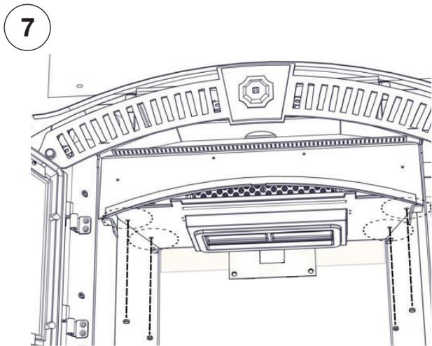
7 Retirez les écrous et boulons de chaque côté de l'appareil, tout en soutenant le déflecteur.
