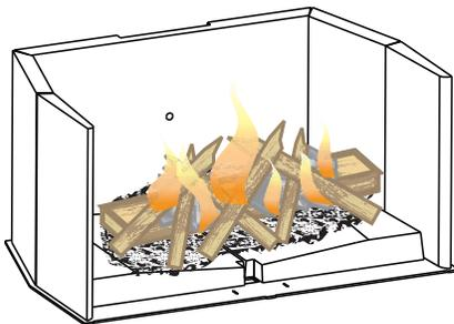
**E.** Lentement, ajoutez des morceaux de bois plus gros (2" x 4"). Posez les morceaux dans le lit de braises, parallèlement à l'arrière de l'appareil, tout en gardant une tranchée peu profonde entre les morceaux de bois. Ainsi l'air comburant primaire circulera directement dans la tranchée et allumera le bois.
