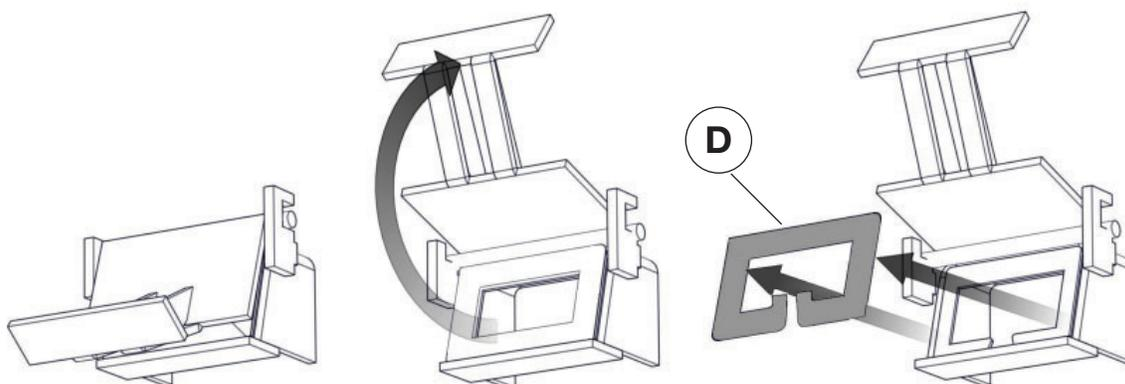
Ouvrez la porte de dilution et retirez le joint d'étanchéité.
