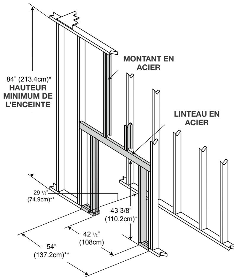
\* Prévoyez l'épaisseur du plancher fini et de la base de protection lorsque vous déterminez ces dimensions.
