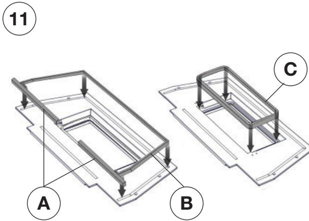
11 Remplacez les joints d'étanchéité A, B, et C. Fixez à l'aide de ruban-cache (non fourni).
