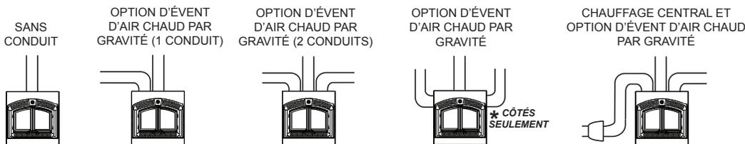
\* S'il est installé avec une cheminée de maçonnerie, le système de chauffage central et l'option d'évent d'air chaud par gravité ne peuvent être installés que sur les côtés.
