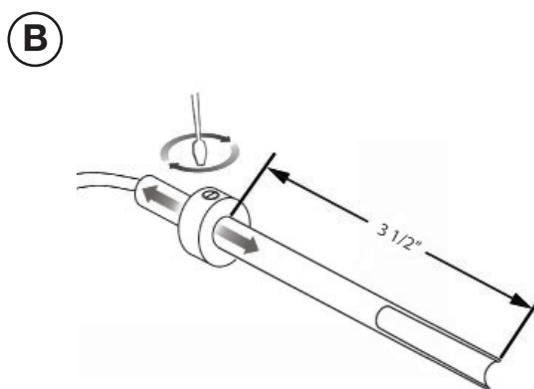
Réglez la profondeur à 3,5" et fixez-le avec la vis de réglage.
