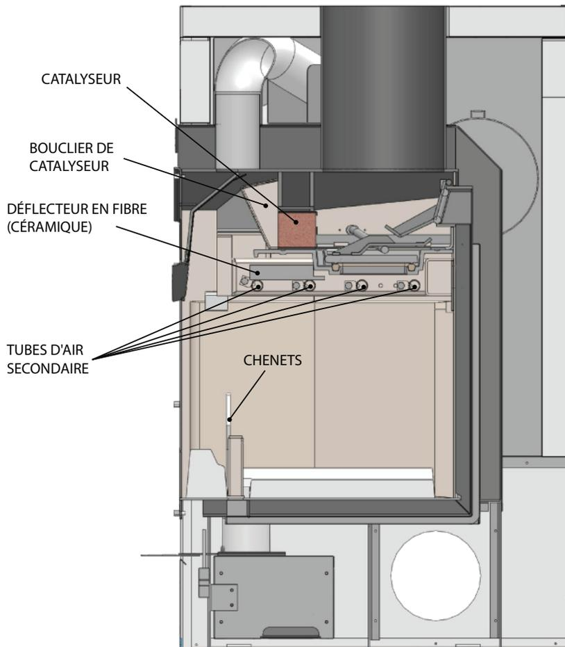
Le NZ3000H comporte un déflecteur en fibre de céramique, un catalyseur et un bouclier de la catalyseur. Il est important d'installer correctement chacun de ces composants avant d'utiliser l'appareil.
