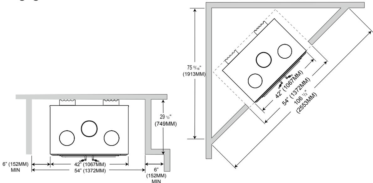
Un minimum de 6" aux matériaux combustibles est requis à partir des côtés de l'appareil.
