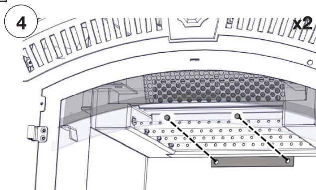
Retirez les deux écrous et boulons avant.
