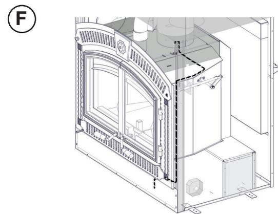
Assurez-vous que la lumière d'indication du moniteur de température catalyseur est visible à travers la garniture inférieure.
