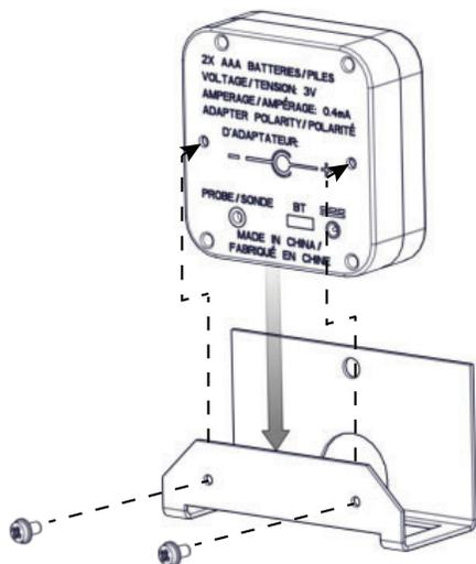
Fixez le nouveau moniteur de température du catalyseur au support nouveau (fourni) à l'aide d'un vis (fourni).
