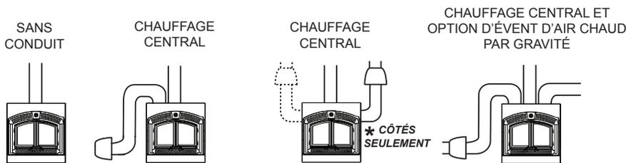
\* S'il est installé avec une cheminée de maçonnerie, le système de chauffage central et l'option d'évent d'air chaud par gravité peuvent être installés que sur les côtés.
