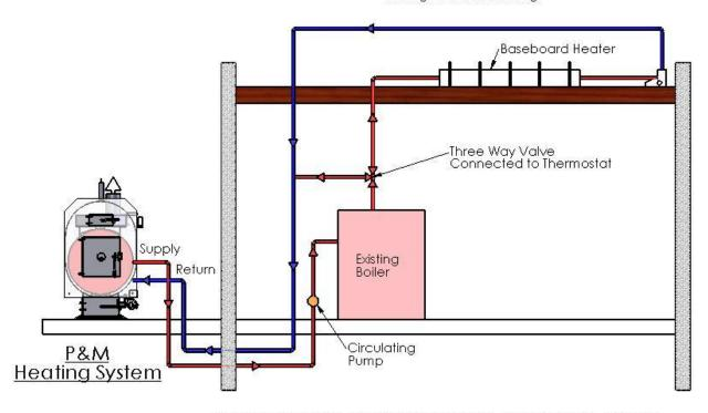
CONNECTING TO AN EXISTING BOILER / BASEBOARD SYSTEM
