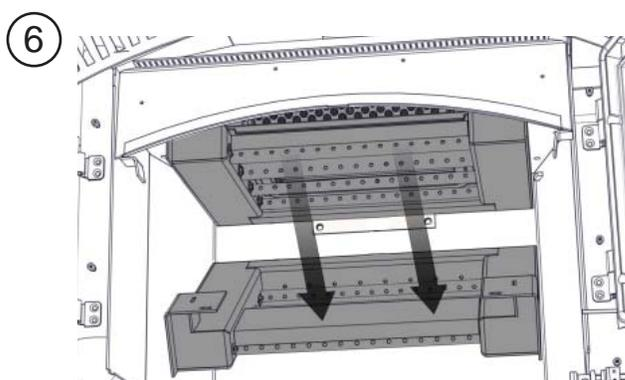
Slide secondary air manifold downward and out to remove. Scrape off gasket from rear and clean surface. Secure new gasket with high temp silicone (not supplied). Retirez le collecteur d'air secondaire en le faisant glisser vers le bas et vers l'extérieur. Ôtez le joint arrière en grattant, puis nettoyez la surface. Fixez le nouveau joint à l'aide d'un silicone haute température (non fourni).
