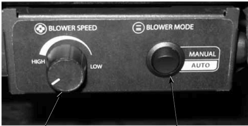
Blower Speed Control Knob (rheostat)
