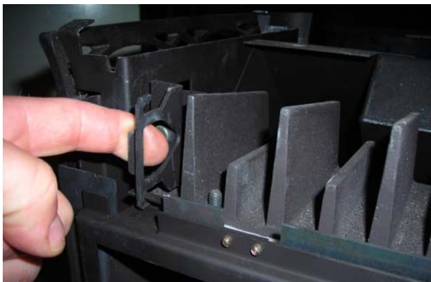
Photo 1 – Détail de l'attache à ressort
