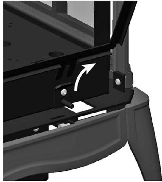
**Figure 15- Attaches /ressorts du bas (*Stud spring*)**
