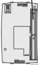
Instalar dos pilas AAA nuevas cuando **Lo Batt** parpadee en la pantalla. **Lo Batt** aparecerá 60 días antes de que las pilas estén completamente descargadas.
