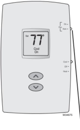
Mueva el interruptor “**FAN**” hasta la posición “Auto” u “On”.
